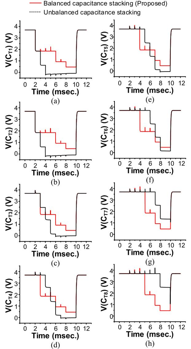
Fig. 13. Voltage across each test capacitor with two different discharging processes. (a)  $C_{T1}$ . (b)  $C_{T2}$ . (c)  $C_{T3}$ . (d)  $C_{T4}$ . (e)  $C_{T5}$ . (f)  $C_{T6}$ . (g)  $C_{T7}$ . (h)  $C_{T8}$ .
